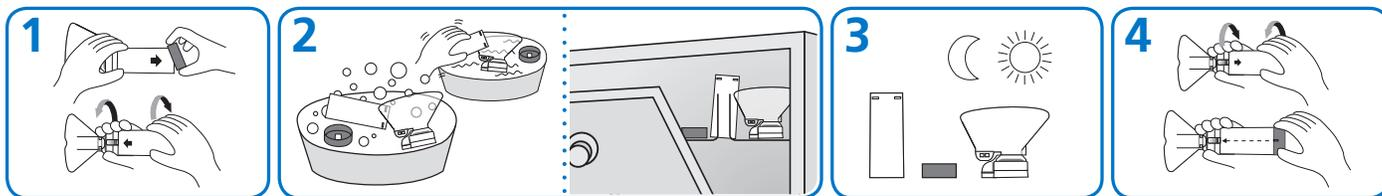
**1** Rimuovere il componente posteriore (D). Per staccare il componente anteriore (B), ruotare la camera come illustrato sopra.
